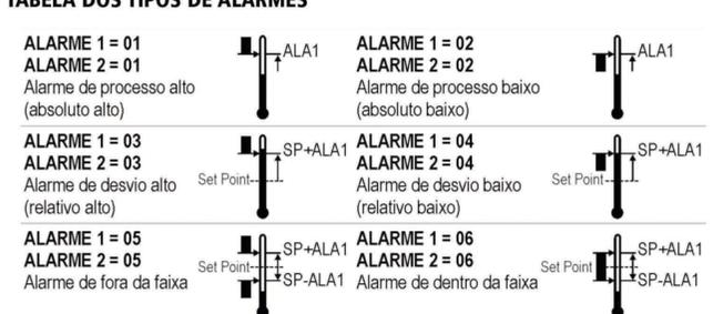
**OBS. 1.** Os tipos de alarme 11, 12, 13, 14, 15 e 16 são idênticos respectivamente aos tipos 01, 02, 03, 04, 05 e 6 porém com a função inibição: a saída permanecerá desligada até a temperatura ter atingido uma vez o set-point, após isto a saída dependerá das condições de alarme.
