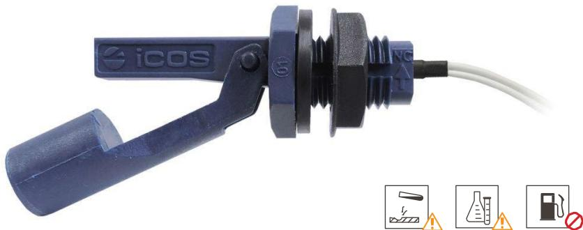
**Funcionamento** Movimento do ltuuador magnético abre/fecha um contato elétrico (reed switch).
