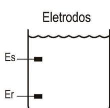
\*Nota: O eletrodo de referência pode ser substituído pela carcaça do reservatório quando o mesmo for metálico.
